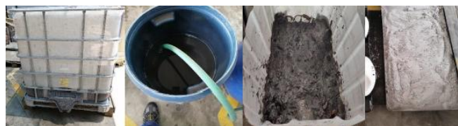
Fig. 1: a) Contenedor de relave. b) Drenado de parte líquida. c) Porción sólida de muestra antes del secado. d) Porción sólida después del secado
