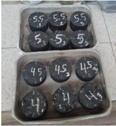
Fig. 8: Briquetas asfálticas bajo el Método Marshall
