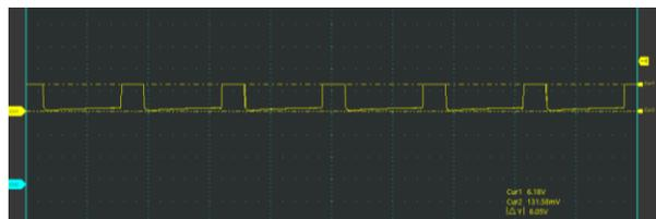
Fig. 15 Válvula de mariposa en posición cerrada (ralentí).
