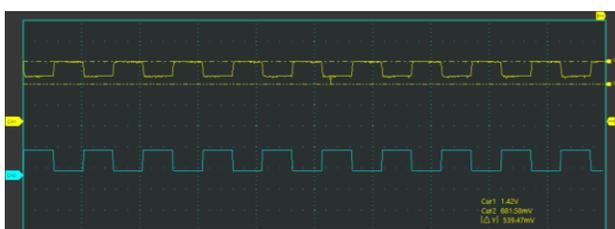
Fig. 22 Medición en pin RSO con la válvula abierta en un 50%.
