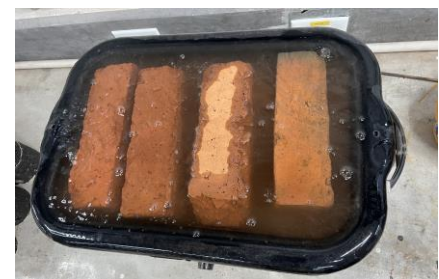
Fig. 4. Pruebas de absorción en agua en el laboratorio de Ingeniería Civil de UNITEC.
