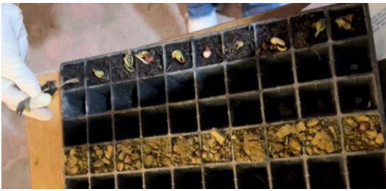
Fig. 3. Comparación de germinación en suelo fértil y lodos residuales de la Planta Potabilizadora (SAC).
