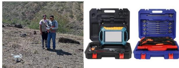
Fig. 1 Levantamiento topográfico con dron DJI Phantom 4 Pro y equipo geofísico ADMT 3000SX – 2D más electrodos.
