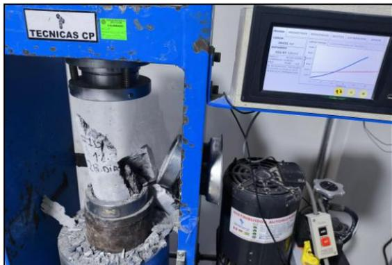
Fig. 2 Ensayo de compresión de probetas cilíndricas
