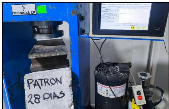
Fig. 3 Ensayo de flexión de probetas prismáticas
