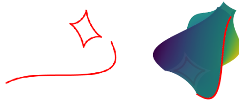
Fig. 9 Superficie generada por una directriz de función seno
