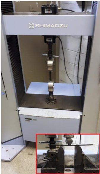
Fig. 1 Máquina universal con equipos para el ensayo de tracción y flexión (en detalle).
