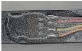
Fig. 5 Protección de los extensómetros con epoxi.
