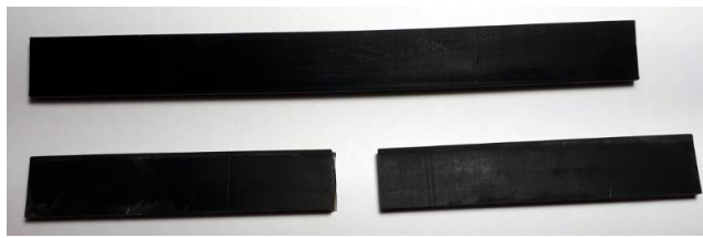
Fig. 23 Los cuerpos de prueba de flexión antes y después del ensayo.
