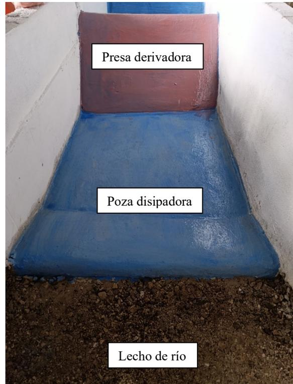
Fig. 4 Modelo físico del modelo (escala 1:25)
