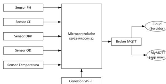
Fig. 1.- Diagrama en bloques de operación del sistema
