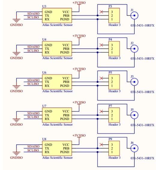
Fig. 6.- Esquemático ADC / Conectores de sensores
