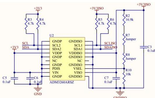
Fig. 5.- Esquemático Aislamiento – DC/DC
