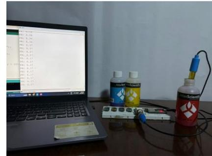
Fig. 10.- Calibración de sensores hidropónicos Atlas Scientific
