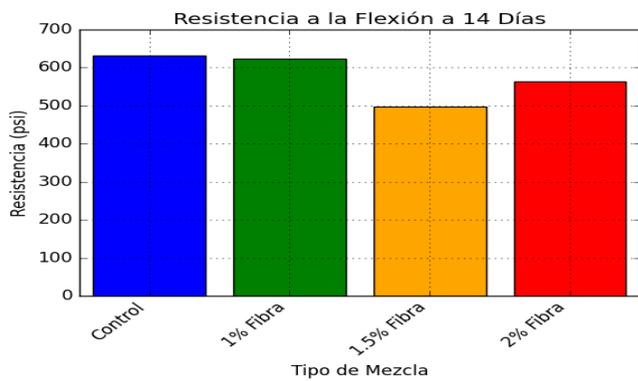
Fig. 6. Resistencia a la flexión a los 14 días
