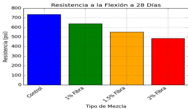
Fig. 7. Resistencia a la flexión a los 28 días
