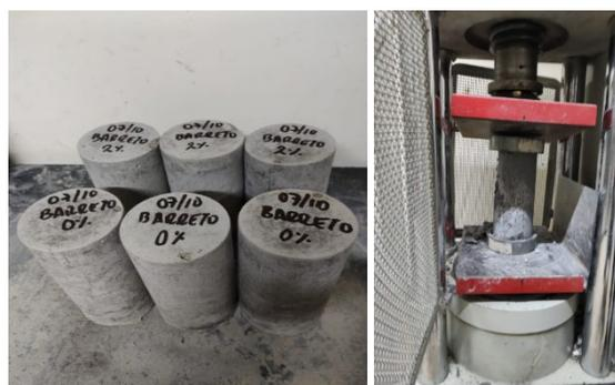
Fig. 6 Ensayo de compresión
