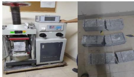
Fig. 7 Ensayo de flexión
