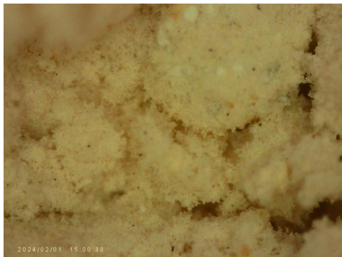
Fig. 8 fotografía de la zeolita recuperada después de la lixiviación y tratamiento cáustico.
