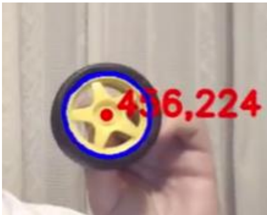
Fig. 18 Ensayo de reconociendo y seguimiento de objetos en función del color del objeto.
