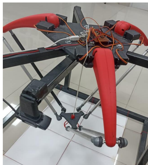
Fig. 22 Robot en físico, con webcam y Arduino mega listo para operar.
