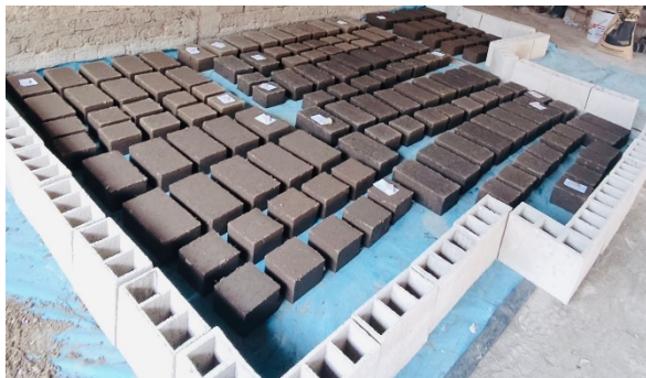
Ilustración 1. Adobes compactados en proceso de secado
