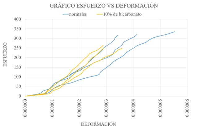
Fig. 1 Resultados Gráficos obtenidos del ensayo de resistencia a la compresión
