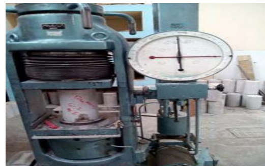
Fig. 9 Probeta sometida a ensayo de compresión axial. Nota. Imagen extraída de [19].
