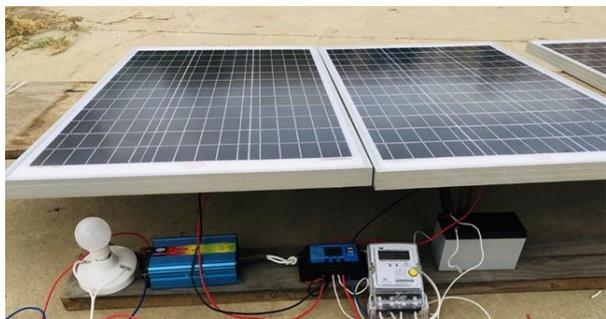
Fig. 3 Sistema Fotovoltaico instalado en la UCT para recopilación de datos
