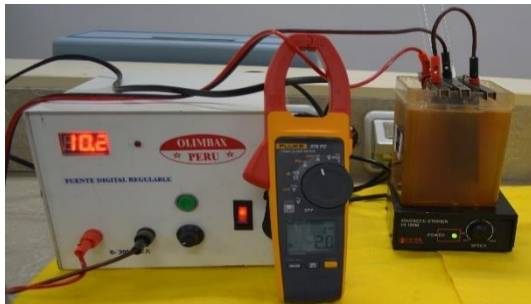
Fig.5 Medida del amperaje correspondiente a 2A, para la primera prueba.
