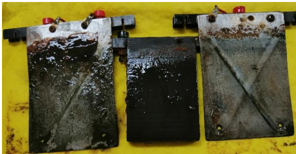
Fig.2 Superficie de los electrodos con una película pasivante por efecto de la falta de agitación.
