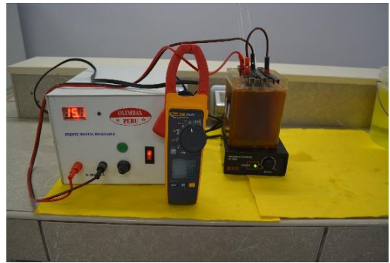
Fig.6 Medida del amperaje correspondiente a 3A, para la segunda prueba.
