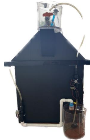
Fig. 8. Montaje del prototipo del sistema automatizado para la recolección, almacenamiento y monitoreo del agua lluvia.
