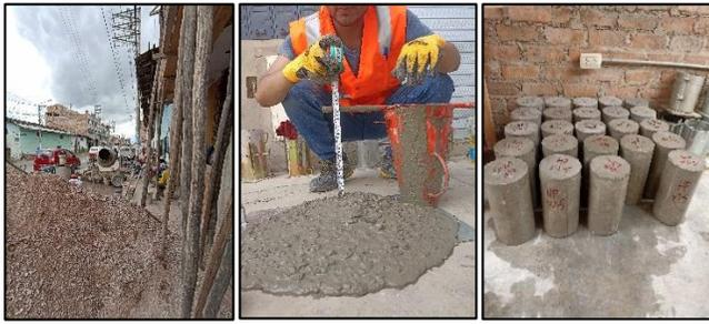
Figura 2. Fotografías de los agregados en obra, ensayo de asentamiento del concreto en obra y especímenes cilíndricos muestreados.
