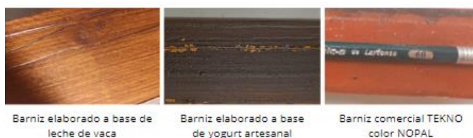
Fig. 7 Resistencia al rayado de los barnices usados en madera
