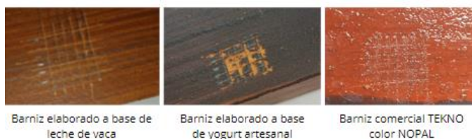
Fig. 3 Resistencia a la adhesión de los barnices usados en madera
