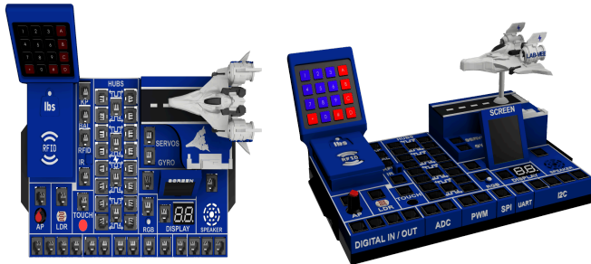
Figura 6. Tarjeta de LAB-VEE para el entrenamiento en lenguajes de programación y dispositivos programables. Fuente: Elaboración propia
