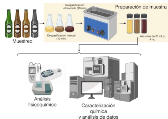
Fig. 1 Metodología para el Análisis Físicoquímico & Analítico de las Muestras de Cerveza Seleccionadas
