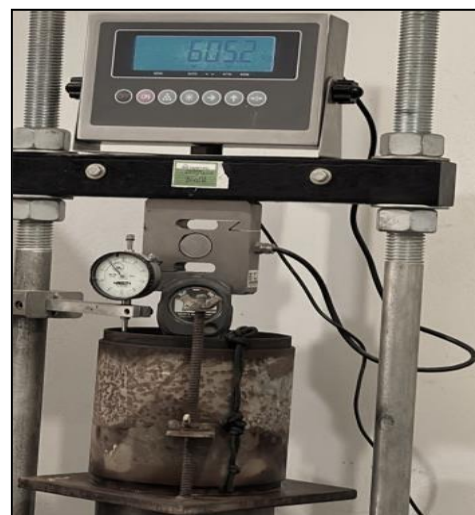
Fig. 2. Muestras CBR sometidas al equipo de carga.
