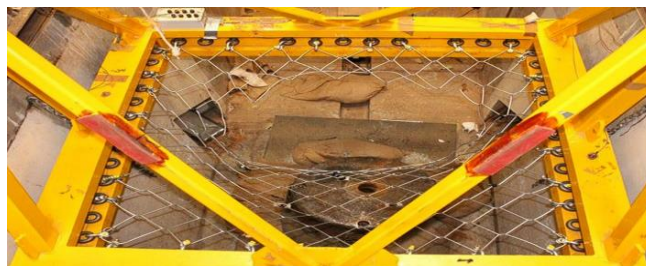
Fig. 6 Ruptura de la malla dinámica
