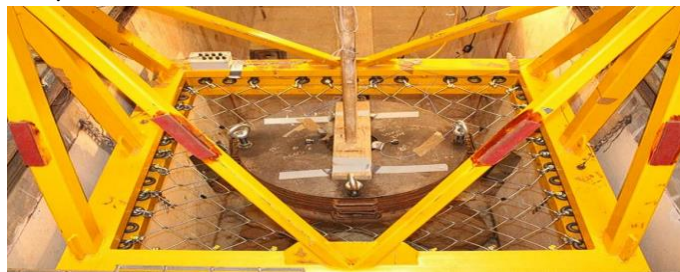
Fig. 3 Ensayo de malla dinámica
