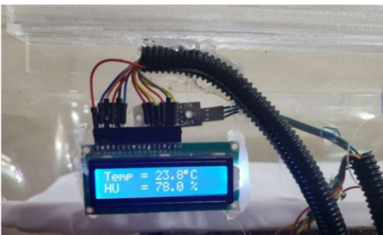
Figura 14: Lectura de temperatura y humedad dentro de la cuna.
