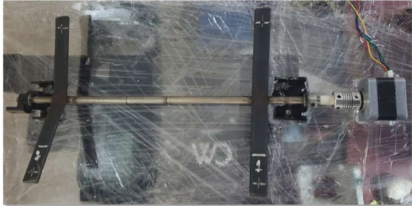
Figura 12: Eje donde ira la base del colchón.
