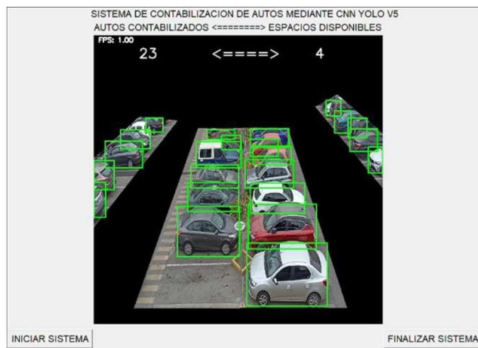
Fig. 12. Cantidad mínima de vehículos contabilizados por el modelo de red YOLO v5 con umbral de 0.35 y 27 espacios de estacionamiento.
