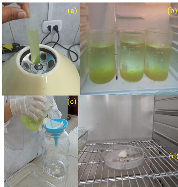
Fig. 1 Extracción del mucílago (a) centrifugación (b) refrigeración (c) filtrado (d) mucílago
