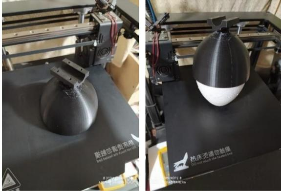
Fig. 13. Proceso de impresión de parte del drone
