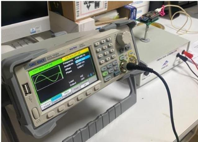
Fig. 4 Disposición del MPU6050 sobre el generador de vibraciones.
