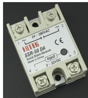
Fig. 18 Relé de estado sólido para la sincronización en CA.
