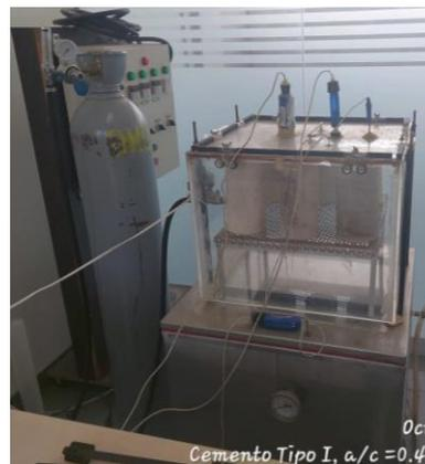
Fig. 2 Muestras en proceso de carbonatación acelerada
