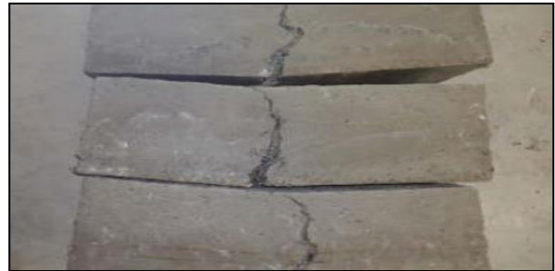
Fig. 2 Fractura del bloque de concreto [4].
