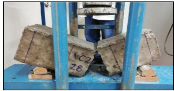
Fig. 4 Viga de concreto convencional después de ensayo a flexión [6]
