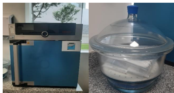
Fig.4. Tratamiento de secado y almacenamiento de muestras
