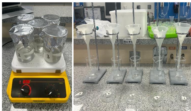
Fig.3. Tratamiento de digestión y filtración de muestras
