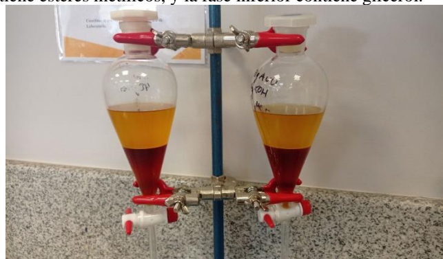
Fig.1. Separación de biodiesel parte superior e inferior glicerol
