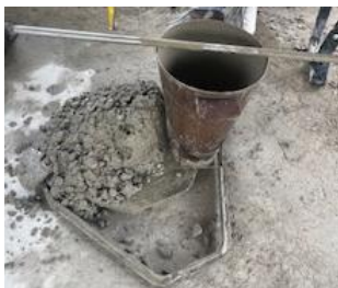
Fig.7 Ensayo de revenimiento del concreto fresco.
