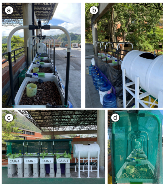
Fig. 2. Prototipo experimental construido del sistema acuapónico de cama de cultivo con sustrato. (a) Lateral izquierdo sin malla de sombra. (b) Lateral derecho sin malla de sombra. (c) Frontal. (d) Lateral izquierdo con malla.
