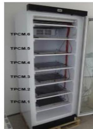
Fig. 3 Congelador usado en el experimento
