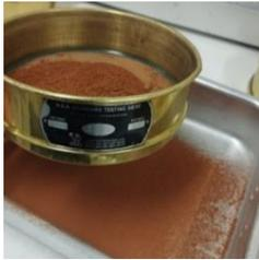
Fig. 2 Proceso de tamizado del polvo de cerámica
