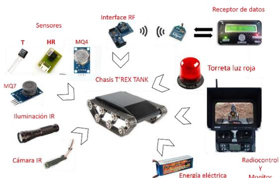
Fig. 6. Pictografía de la instrumentación en el robot móvil para minería subterránea.
