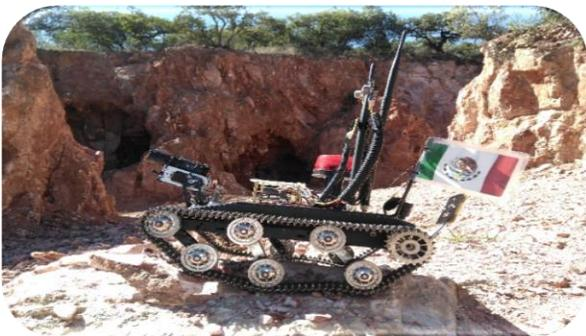
Fig. 13. Robot móvil radiocontrolado para detección de gas tóxico (CO) o explosivo (CH4) en minas subterráneas de México.
