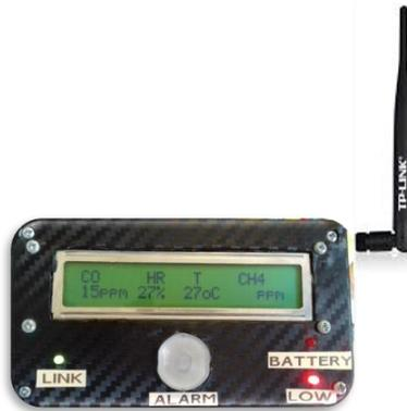
Fig. 18. Módulo portátil de recepción de datos.
