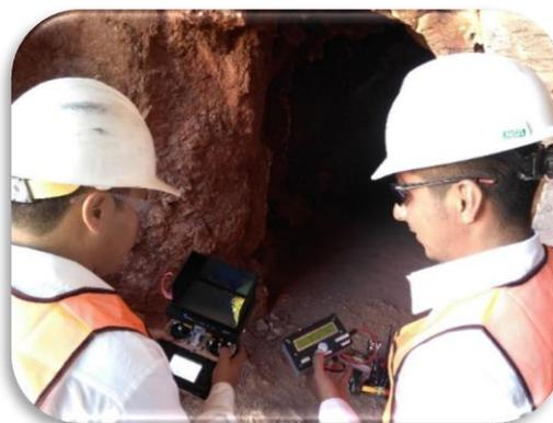
Fig. 16. Prueba de radiocontrol del robot móvil para minas subterráneas.
