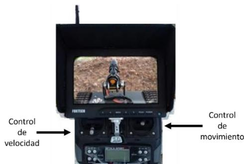
Fig. 15. Radiocontrol de desplazamiento, velocidad y monitor de video.
