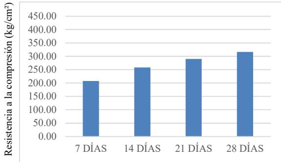
Figura 2. Resistencia promedio alcanzada por probetas curadas dos veces al día.
