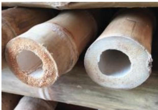
Fig. 5 Fibras de bambú y sección circular.
