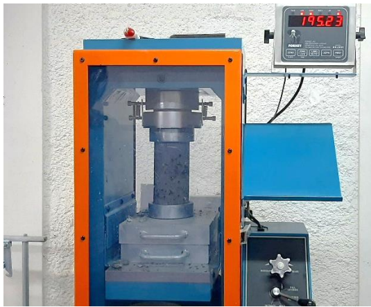
Fig. 7 Ensayo de resistencia a compresión de concreto
