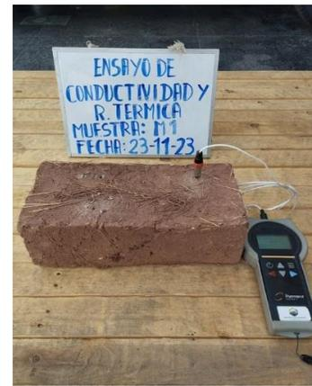
Fig. 4 Equipo de medición de conductividad térmica
