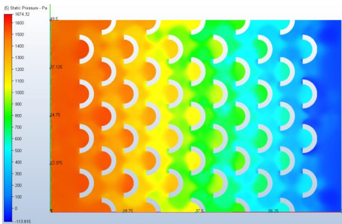
Fig. 14 Distribución de presión de 10 Pa con velocidad de 100 cm/s. (Fuente: Elaboración propia)
