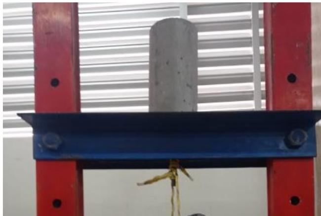
Fig. 5 Cilindro apoyado sobre viga metálica
