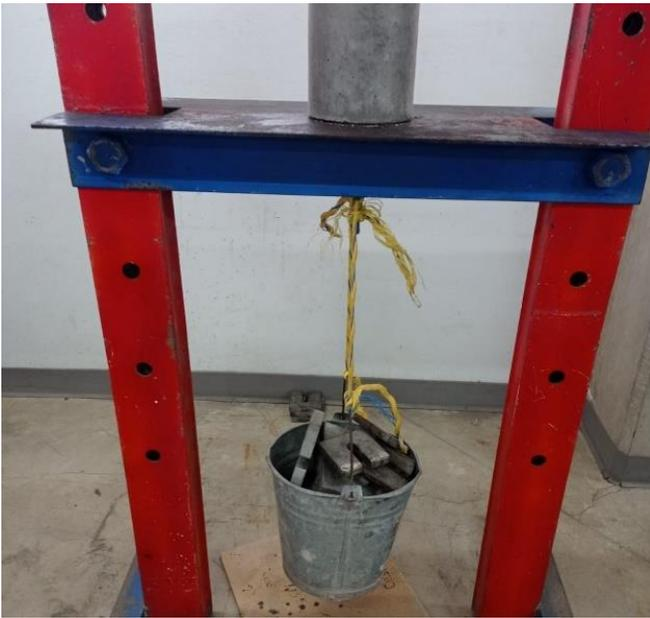
Fig. 6 Carga aplicada sobre la varilla principal
