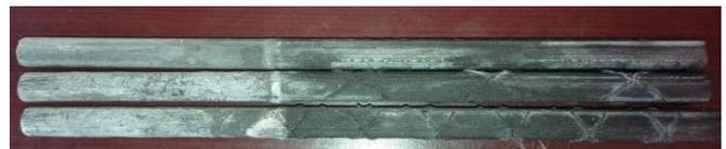
Fig. 8 Varillas extraídas con pérdida de corrugas y parte de su material
