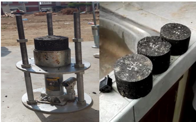
Fig. 5 Briquetas de asfalto modificada con fibra de vidrio
