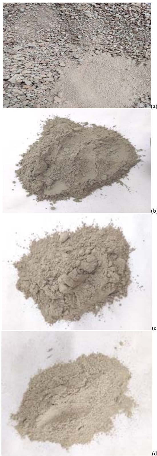
Fig. 1 Study materials (a) clay (b) cement (c) limestone dust (d) RCA fines.
