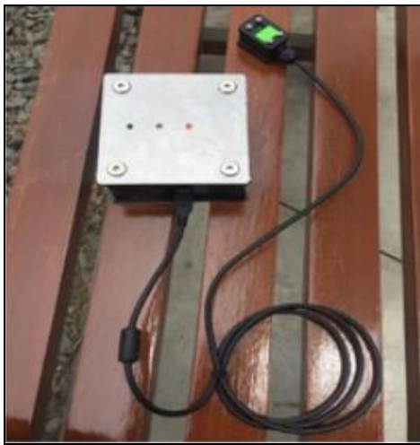
Fig. 7 Datalogger y sensor de calidad de aire
