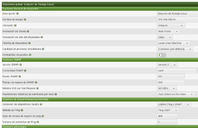
Fig. 5. Aspectos de configuración para la inclusión de una estación de trabajo con Linux
